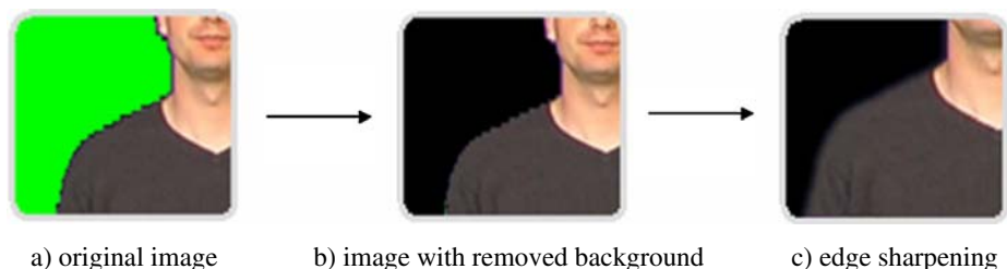
Fig. 2 Edge sharpening procedure
