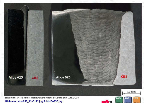
Abb. 9: Vergleich Elektronenstrahl und Stabelektrode, 50mm
