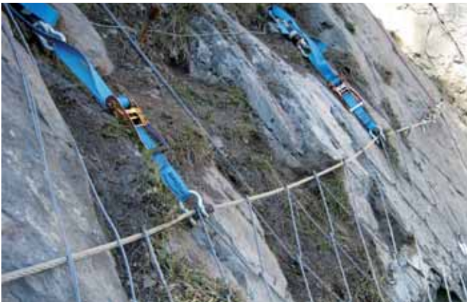
Bild 34. Obere Aufhängung bei Versuchsbeginn.
