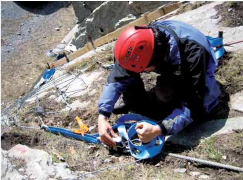
Bild 16. Messung der Richtung und Neigung der Kraftmessdosen mit Geologenkompass und Neigungsmessgerät.
