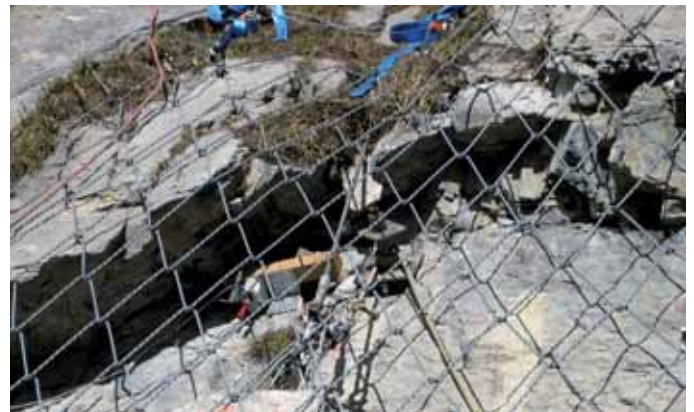
Bild 13. Blockaufhängung und Wegmessung.
