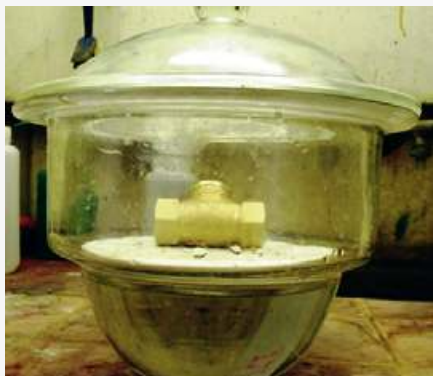
Fig. 8: A (6l) desiccator for the implementation of the 5% ammonia test on the straight-seated valve 1 Bild 8: Exsikkator (6l) zur Durchführung des 5% Ammoniaktests am Geradsitzventil 1
