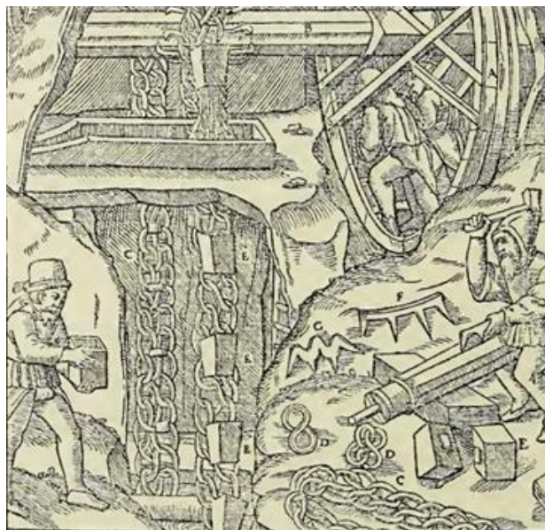
Abbildung 1: Kettenbecherwerk (16. Jahrhundert) [AGR56]
