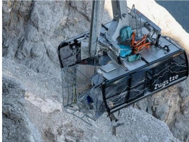
Abbildung 4: „Kette eines Hebwerkzeuges reißt und löst Kettenreaktion aus“ [MER18]
