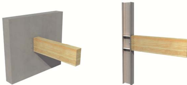
Abbildung 17: in Entwicklung befindliche Anschlussvarianten von SHERPA-Verbindern an Beton (links) und Stahl (rechts)
