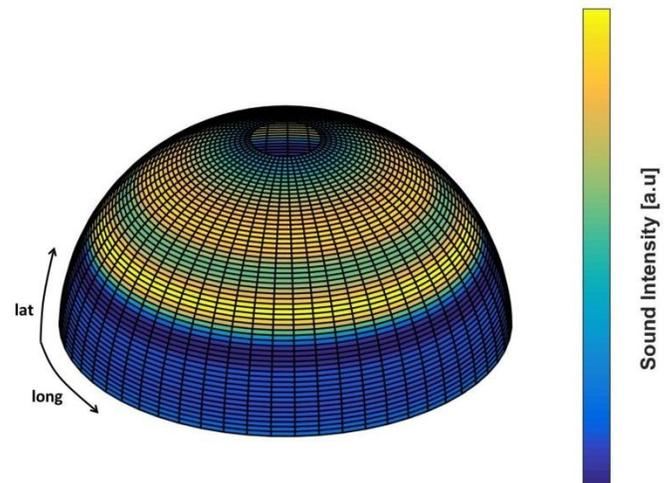
FIGURE 4: DISTRIBUTION OF SOUND INTENSITY AT 212Hz ON A HEMISPHERE AROUND THE FLAME, MEASURED WITH PP-PROBES
