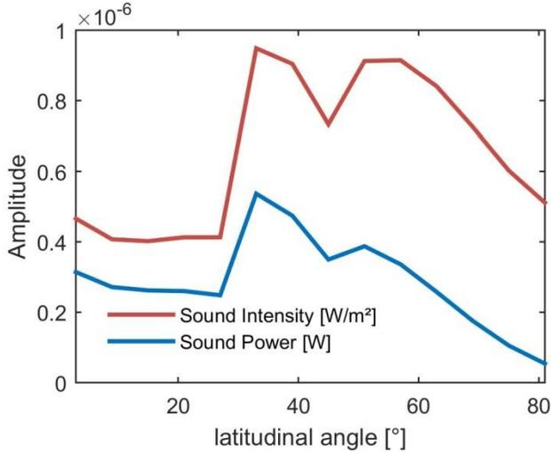
FIGURE 5: LATITUDINAL DISTRIBUTION OF SOUND INTENSITY AND SOUND POWER AT 212HZ, MEASURED WITH PP-PROBES
