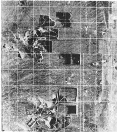
Abb. 7: Ausschnitt eines SLR-Orthophotos (siehe Leberl und Fuchs, 1978). Goodyear-SAR, 3 cm Wellenlänge, 12 km Flughöhe. Maschenweite des Gitters 2 km.
