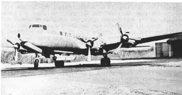
Abb. 10: DC-6 Flugzeug mit SLR-Antenne für reale Apertur (bis 1974 benutzt von Westinghouse, USA, für kommerzielle Befliegungen).
