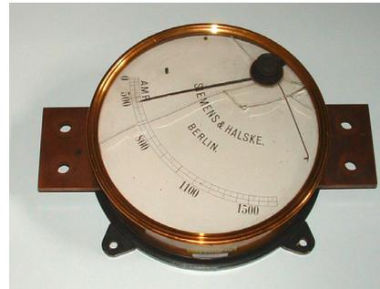
Bild 1: Strommesser auf Potenzial, S&H, um 1890
