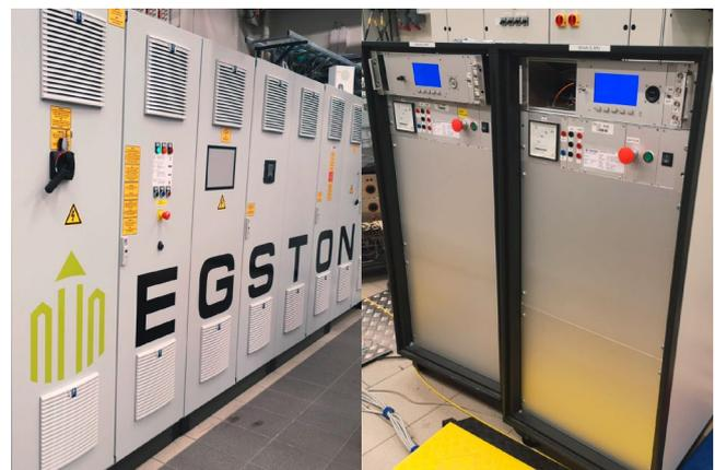
National Smart Grid Laboratory: Netznachbildung für AC und DC (links) und zwei 2-level VSCs (rechts)
